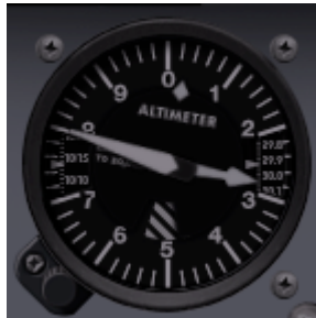
Ein typischer Höhenmesser, wie man ihn bei einmotorigen Maschinen häufig antrifft.
